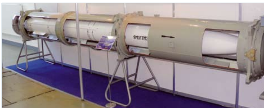
↑ Przeciwlotniczy pocisk raketowy 9M317ME w pojemniku transportowo-startowym.
