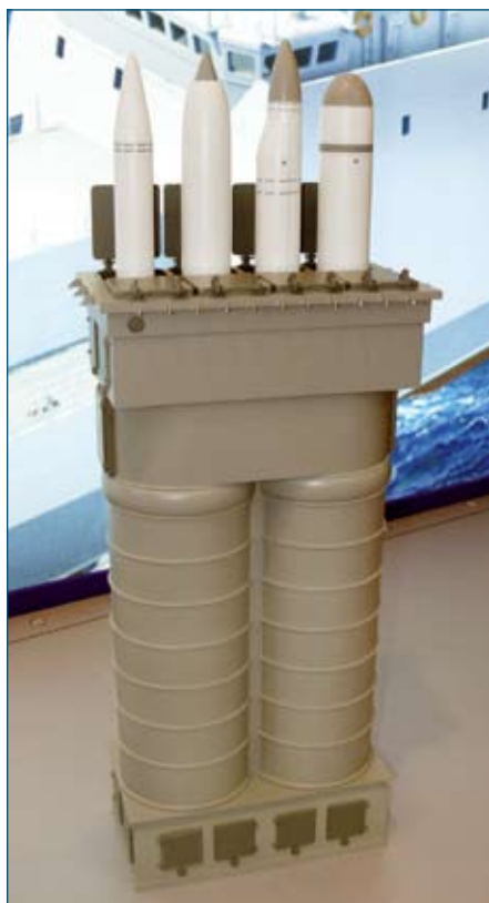
↑ Uniwersalny system pionowych wyrzutni UKSK z różnego typu pociskami systemu Kalibr i pokpr Jachont .
