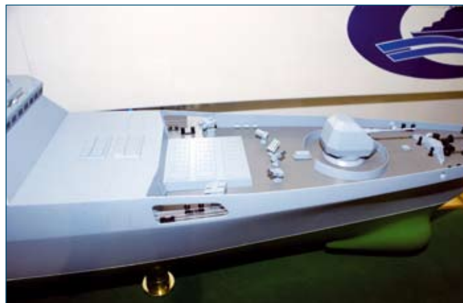
↑ Widok pokładu dziobowego i pokładówki kryjącej wyrzutnie systemów Kalibr-NKE oraz Sztıl-1 . Zwracają uwagę również armata A-192E i wyrzutnie KT-308-5. Zastanawiającym rozwiązaniem jest skupienie wszelkich wyrzutni rakiet na dziobie, podczas gdy śródokręcie i rufa fregaty są „puste”. Prostokątne pokrywy w burtach kryją wyrzutnie systemu POP Pakiet-E/NK .
