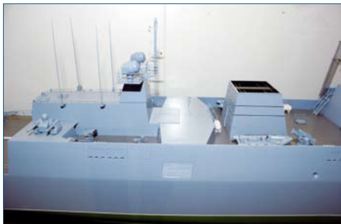
↑ Śródokręcie i hangar fregaty wersji eksportowej proj. 22356. Widoczne są stanowiska systemów Palma-E oraz wyrzutnie celów pozornych – jedyne uzbrojenie w tej części okrętu. Duże prostokątne pokrywy pomiędzy kominem a antenami Oriech kierowania ogniem Sztıla-1 , zamykają szyby serwisowe siłowni.
