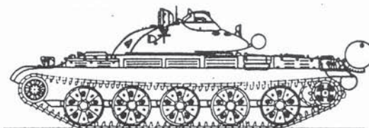
Рис.2. Истребитель танков ИТ-1 с ПТУР "Дракон" в качестве основного вооружения
