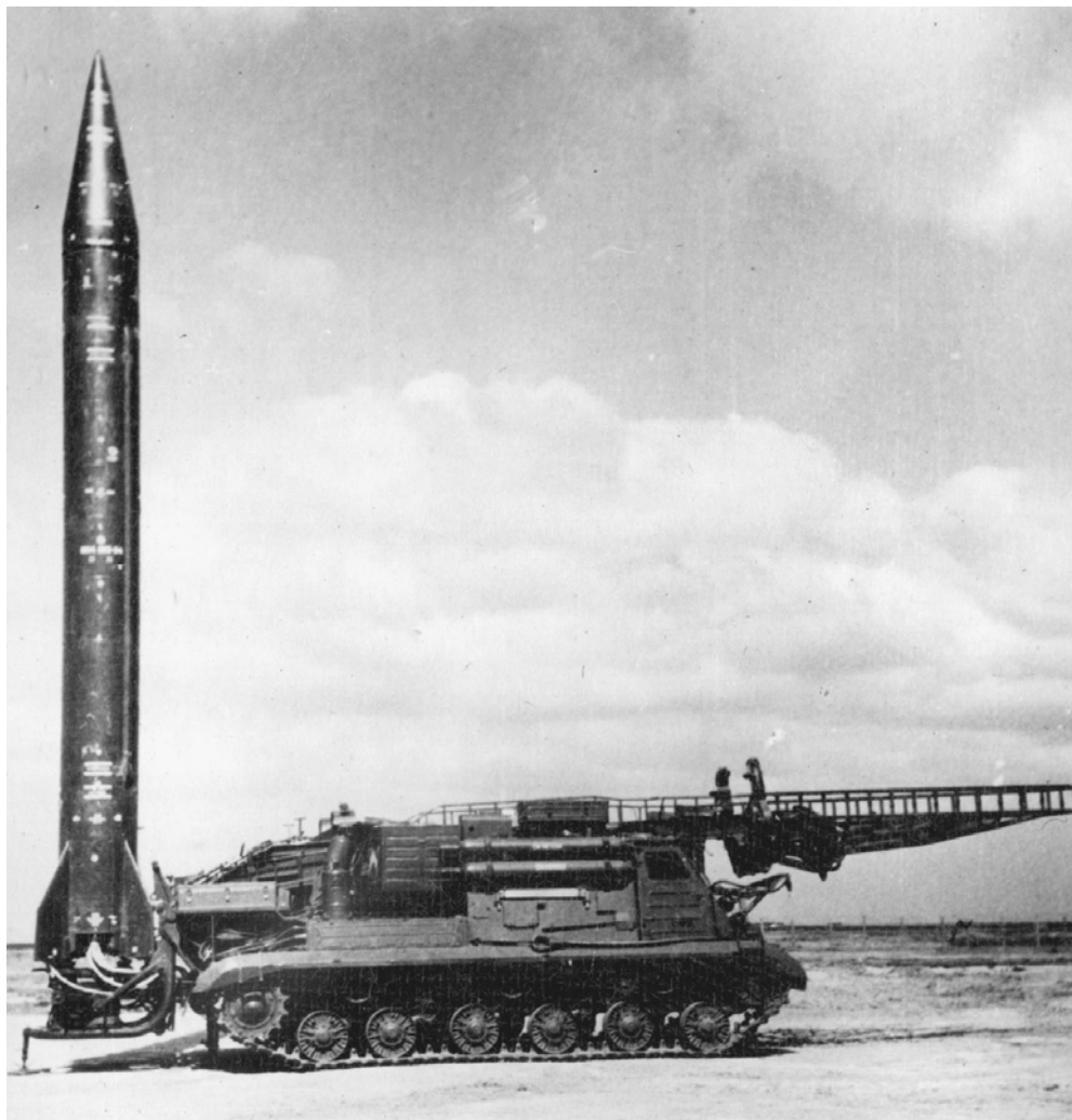
Ракета Р-17 на гусеничном стартовом агрегате 2П19 (фото Макавенко, ГЦП-4, 1961 год)
