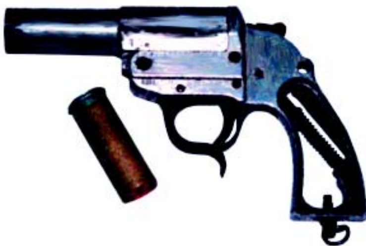
Гладкоствольный сигнальный пистолет (ракетника) системы Валтера и отечественный сигнальный патрон. Калибр 26,5 мм, вес пистолета 0,71 кг, длина пистолета 250 мм
