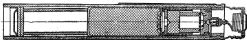
30-мм реактивный осветительный патрон увеличенной дальности
