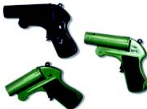
Сигнальные пистолеты СП-81. Калибр 26 мм, скорострельность, 10-12 выстр./мин, высота заброса осветительной или сигнальной звездки не менее 90 м, длина 175 мм, высота 130 мм, масса (без кобуры) 0,6 кг, условия эксплуатации ±50 °С.
