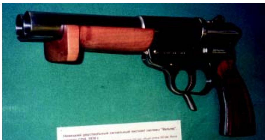
Немецкий двуствольный сигнальный пистолет системы "Валтер", модель СЛД, 1936 г. Калибр 4 охотничий (26,65 мм). Длина ствола 290 мм, общая длина 340 мм. Масса без патронов 2650 г. Пистолет оснащен переводчиком огня, позволяющим давать сигналы из правого, левого или обоих стволов сразу (ВИМАИВиВС, Санкт-Петербург)
