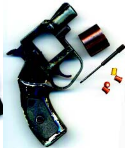
Реvolver сигнальный РС-22. Масса не более 0,385 кг, габаритные размеры 12,4x115x35 мм.
