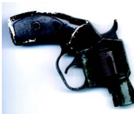
Реvolver сигнальный РС-22. Масса не более 0,385 кг, габаритные размеры 12,4x115x35 мм.
